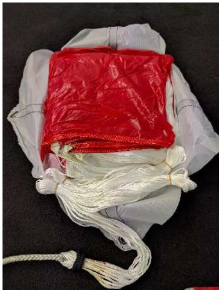
20. Installer les lignes regroupées à l'intérieur du pod.
