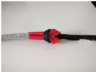
22. Connecter le secours et l'élévateur en Y (fourni avec la sellette) en tête d'alouette. La connexion doit être centrée sur la gaine rouge de la bride.
